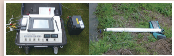
使用した測定装置 (左: 記録装置、右: 磁場センサー)
