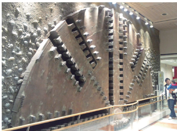
図2 シールドマシンの先端部(上半分のみ)。このプレートを回転させて地盤を掘り進む。地下鉄博物館にて筆者撮影。
