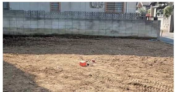
図3 3成分McSEIS-AT 測定状況
