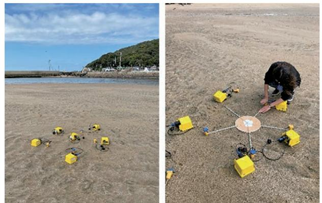
図1 砂浜での実験の様子(左)とオリジナルの地震計設置用装置(右)
