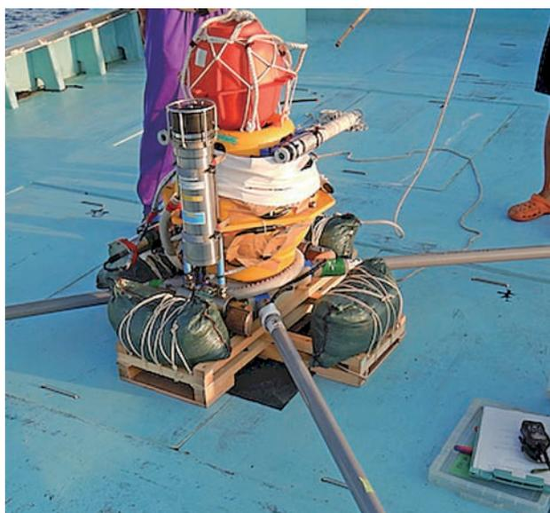
図1 投入前の海底電位磁力計(OBEM)
