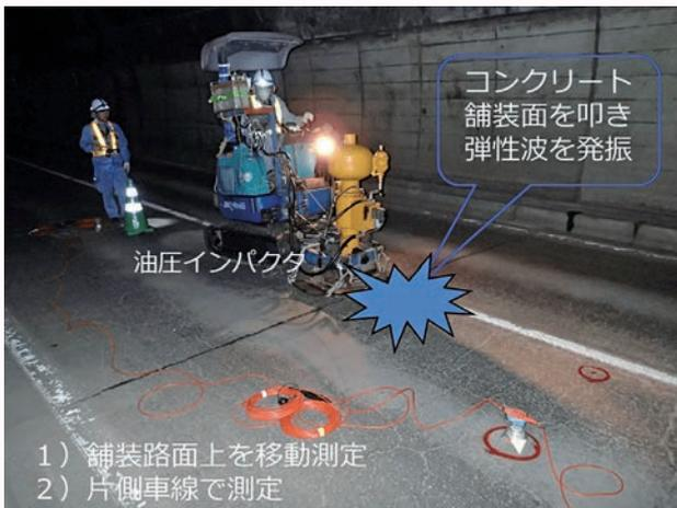
図3 トンネル坑内での屈折法弾性波探査
