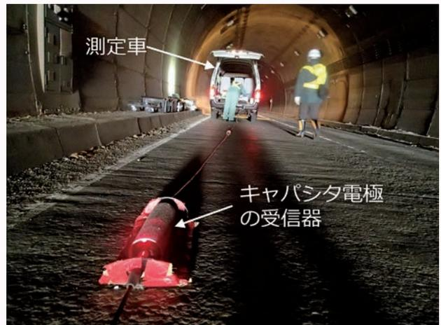
図4 トンネル坑内での比抵抗探査
