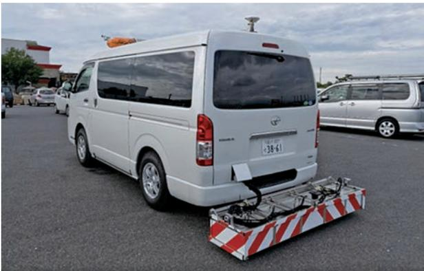
図4 車載型地中レーダ装置(探査車)の例
