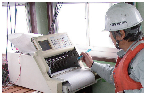
第6図 観測台船における磁気測定状況(多ベンレコーダー使用)
