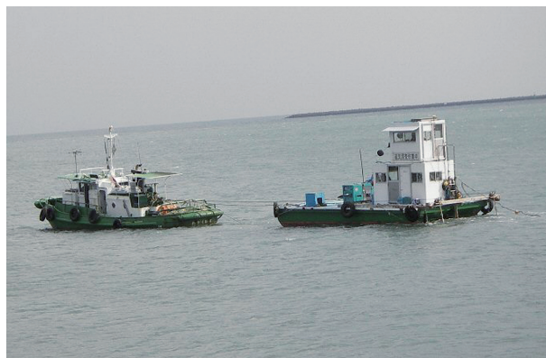
第7図 探査航行状況、前は曳き船、後は観測船
