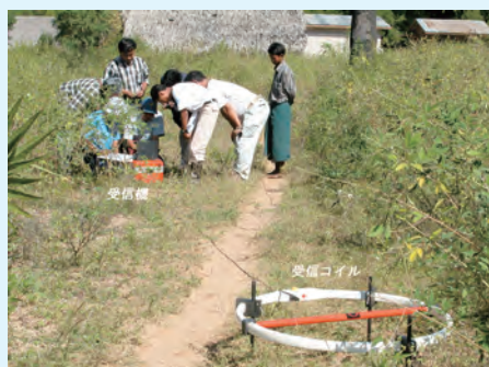
Fig.3.14 TEM法による地下水調査
