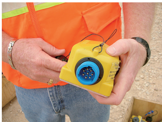
写真1 4ch仕様の独立型探鉱機GSR 重量約1kg
