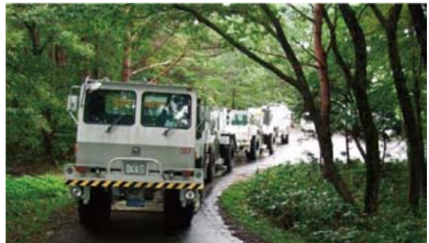
山間部でのパイプレータ発震作業
