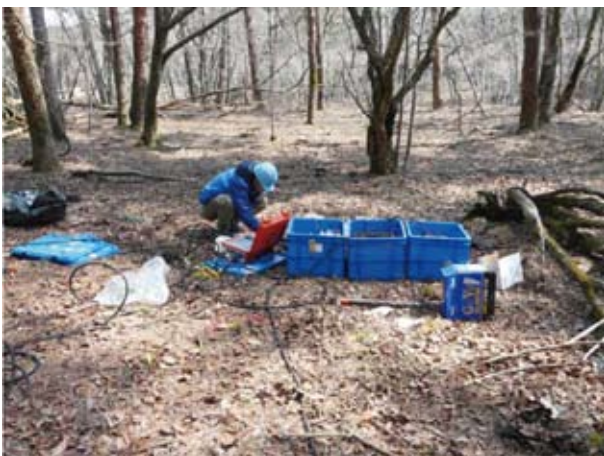
図2 観測風景 測定はMetronix社製のADU07を用いた。消費電力が高目なため(DC12V、1.6A程度)、105Ahのディープサイクルバッテリーを7個並列にし、18日間連続でデータを取得した。磁場参照点は宮城県丸森町に設置したが、東北地方太平洋沖地震の余震活動のためデータはやや乱れてしまった。
