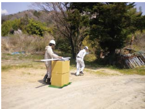
写真-5 電磁マッピング(スリングラム)測定状況
