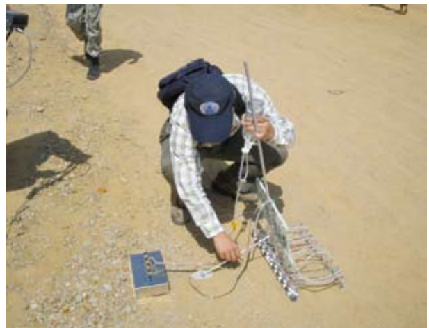
電気探査による砂漠での地雷探査実験
