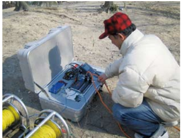
マルチチャンネル電気探査装置による遺跡探査
