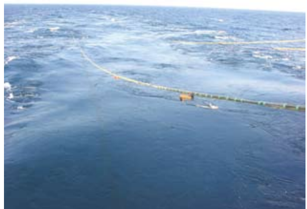
写真5 揚収中のストリーマケーブル ケーブルの所々にケーブル深度調整器や緊急浮上装置、音響測定装置などが取り付けられている。
