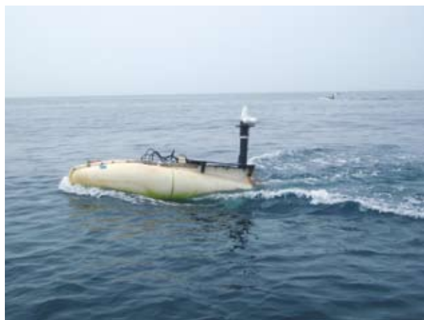
写真6 ストリーマケーブルの終端についているテールブイ「資源」の5,000m以上後方にこのようなブイが100m間隔で10個並んでいます。他の船が見たら潜水艦の一部と勘違いするかも?
