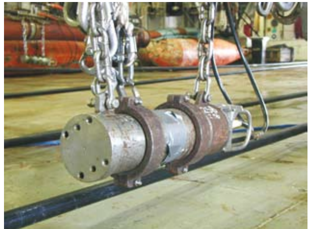
写真4 高圧空気を一瞬で海中に放出するエアガン エアガンはフロートに吊るされており、一度に28個のエアガンが発震します。
