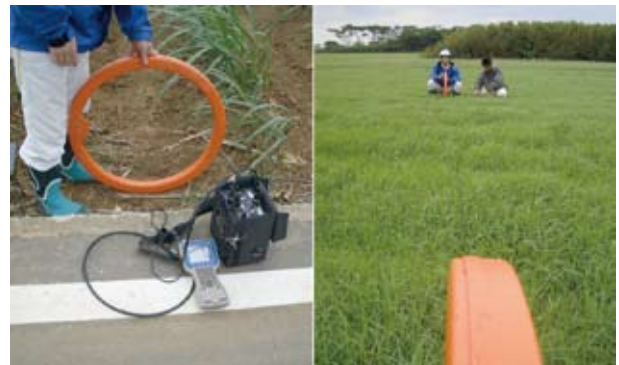
Fig.2 電磁探査機器(左)と測定風景(右：手前が受診受信コイル、奥が送信コイル)
