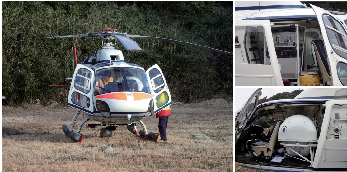
図2 ヘリコプターに搭載された重力偏差計(Heli FALCON ® )。(a) 全景。操縦士席の後ろに制御装置が、副操縦士席の後ろに重力偏差計がセットされている。(b) 制御装置。(c) 重力偏差計(中央の白い物体)。著者撮影。
