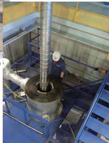
(掘削同時検層機の耐高温高圧試験)
