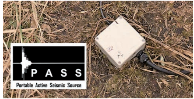
図4 小型震源装置PASSの写真。白いケースに振動子が内蔵されている。サイズは1辺10cm程度。
