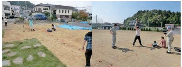
東日本大震災で全壊した住宅の宅地における表面波探査 (岩手県奥州市)。
