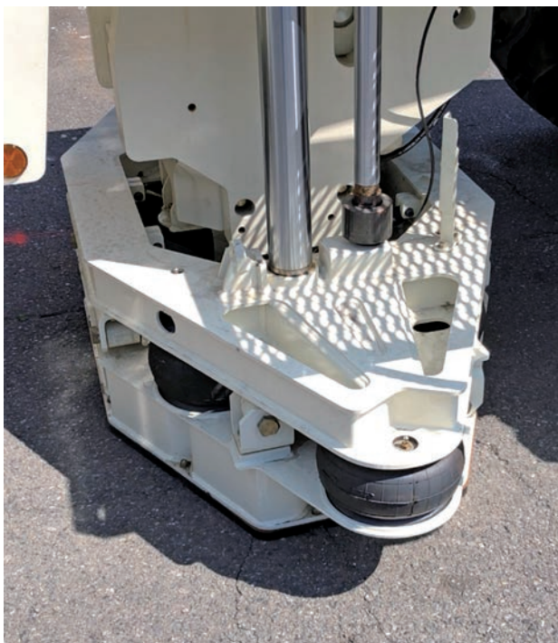
写真2 地面とのカップリング機構
