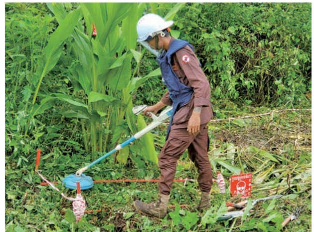
図3 カンボジアなど地雷被災国で活躍する東北大学が開発した地雷検知用GPR (ALIS)
