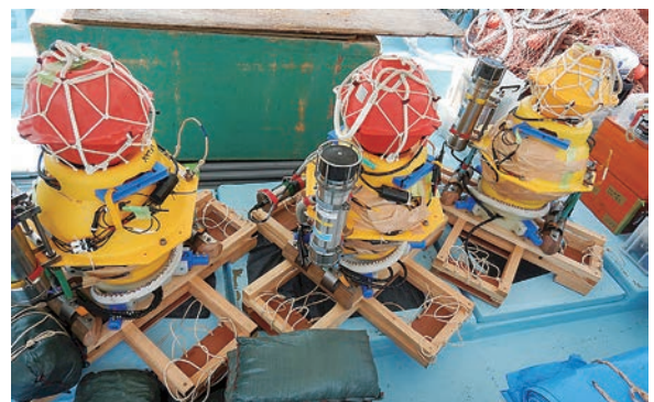
図2 船上で木枠に土嚢袋を取り付け作業中のOBEM
