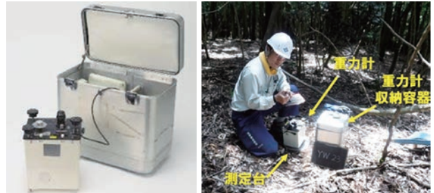
写真1 LaCoste & Romberg社製D型重力計(左)、測定の様子(右)
