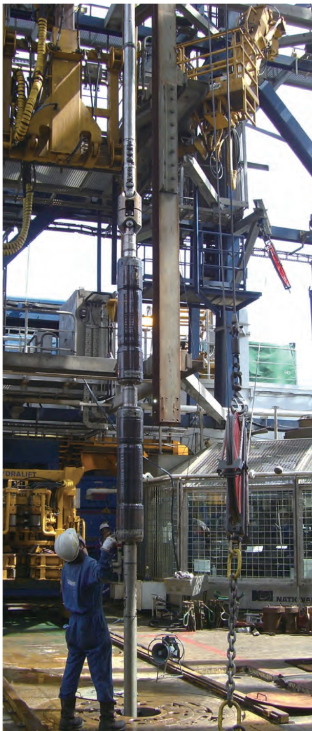
図4 第319航海で実施された、孔内現場応力・間隙圧等を計測するための地層テスター。黒い細長いものがバッカーで、これを膨張させてその間を遮蔽し、間隙圧を計測したり、水圧破碎実験を実施する。
