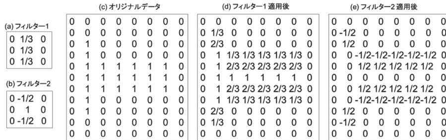
図4 畳み込み層でのフィルター適用
