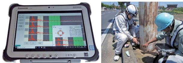
道路附帯物・鋼製柱腐食診断装置
