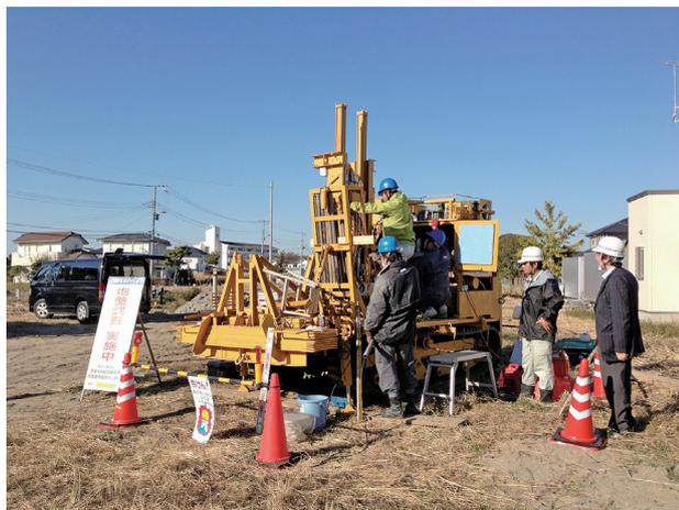
写真1 コーン貫入試験による液状化調査
