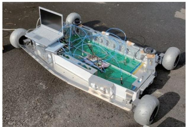
図4 GPR装置の構成例(東北大学X-Yakumo)
