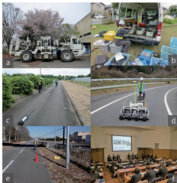
図2 (a) 大型S波バイブレータ(Mertz社製、総重量：26,700kg)、(b) 表面波探査、(c) 研究所内でのオームマップ探査、(d) 舗装走行実験場におけるマルチチャンネル地中レーダ探査、(e) 研究所敷地内での探査試験の様子。表面波探査の際に歩行振動を有効に利用しています。(f) シンポジウム「物理探査を維持管理や防災にどう活かすのか」の質疑応答
