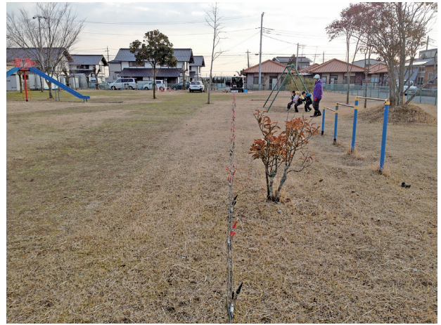
写真2 電気探査による液状化調査
