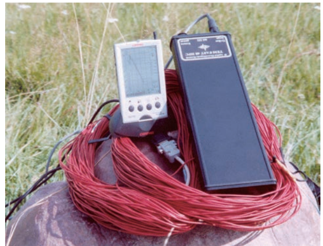
図7 TEM法調査装置「TEM-FAST48」
