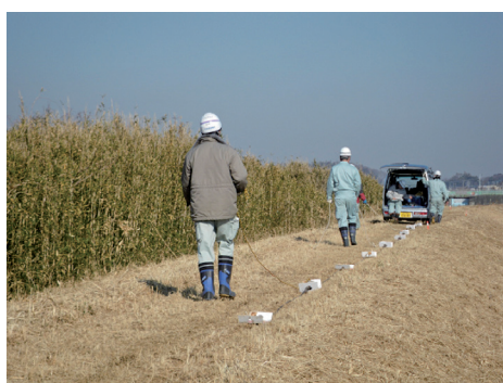
牽引式電気探査測定状況
