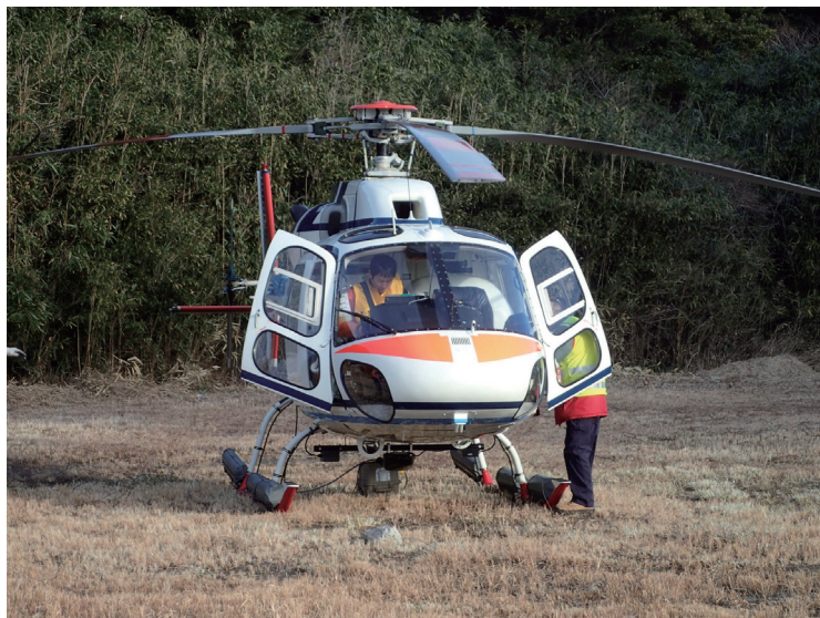
図2 ヘリコプターに搭載された重力偏差計(Heli FALCON ® )。(a) 全景。操縦士席の後ろに制御装置が、副操縦士席の後ろに重力偏差計がセットされている。(b) 制御装置。(c) 重力偏差計(中央の白い物体)。著者撮影。
