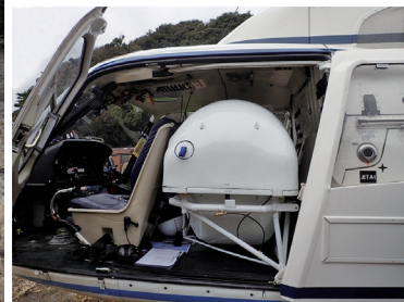
図2 ヘリコプターに搭載された重力偏差計(Heli FALCON ® )。(a) 全景。操縦士席の後ろに制御装置が、副操縦士席の後ろに重力偏差計がセットされている。(b) 制御装置。(c) 重力偏差計(中央の白い物体)。著者撮影。
