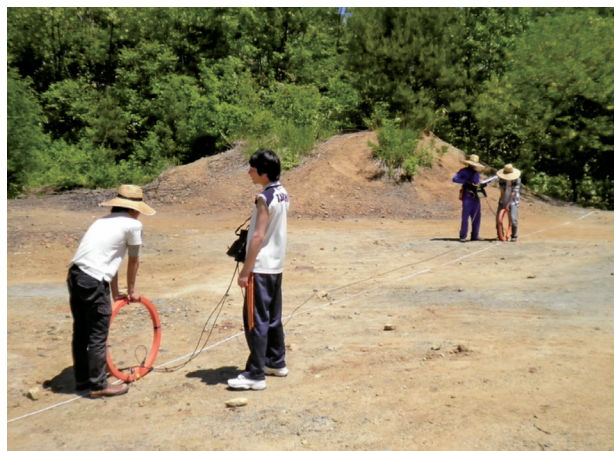
図2 ループループ法の探査風景(秋田大学坂中先生ご提供)。
