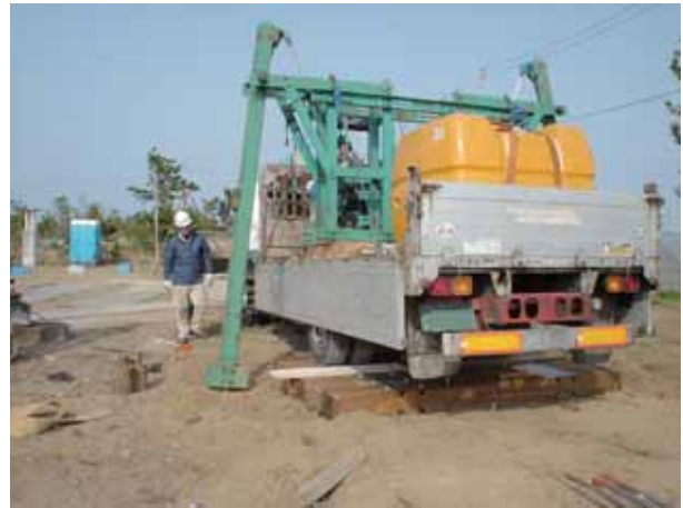
写真2 大深度VSP探査用のS波震源(特許取得)。様々な深度に対応したS波震源を各種とり揃えています。写真は2,000m級です。
