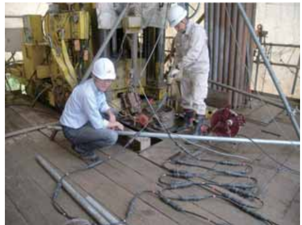
写真6 ハイドロフォンVSP探査で観測孔へ受振器を投入中。詳細な地質構造を把握するため受振器間隔50cmを採用しました。条件に合わせて1m、2m、5mと受振器間隔を選択でき、深度1,000m級まで対応しています。
