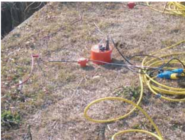
写真5 広帯域の周波数特性を持つMEMS型受振器と従来型2Hz地震計との比較実験中。低周波領域の利用価値に注目しています。
