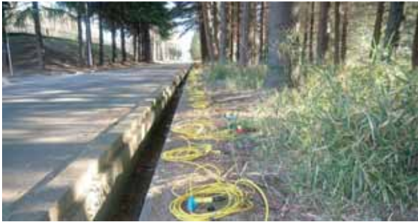
写真4 地震波干渉法のための多チャンネル長時間記録を測定中。従来の反射法地震探査ではノイズとなる周辺交通振動や自然地震などを利用します。
