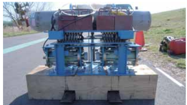
写真7 極浅部の探査用に開発した人力で移動できるコンパクトなSH波震源。エアピストンを2基搭載しサイクリックな右左叩きが可能です。
