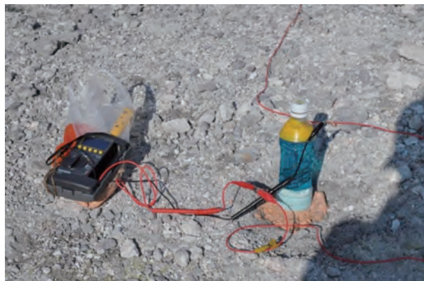
図2 知床硫黄山での自然電位測定の様子
