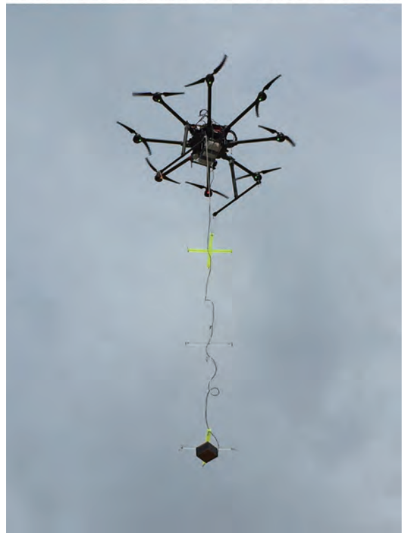
写真6 マルチコプターを用いた空中電磁探査の開発
