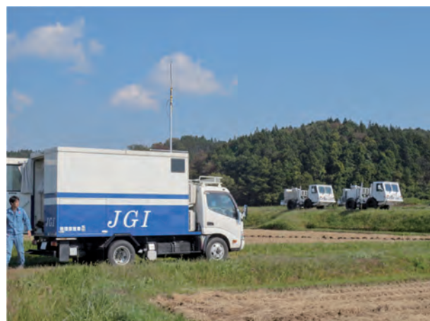
図2 秋田県由利原油田周辺の3次元地震探査(2014年)。観測車(手前)と中型バイブレータ(奥)、最大チャンネル4597chでデータ取得。良い天気であっても次々と記録が出てくるので、車内で過ごすことが多いです。
