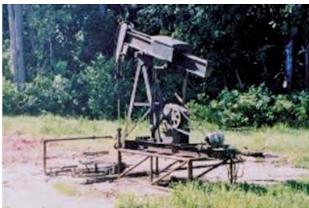
写真1 穿孔により再生した油井
