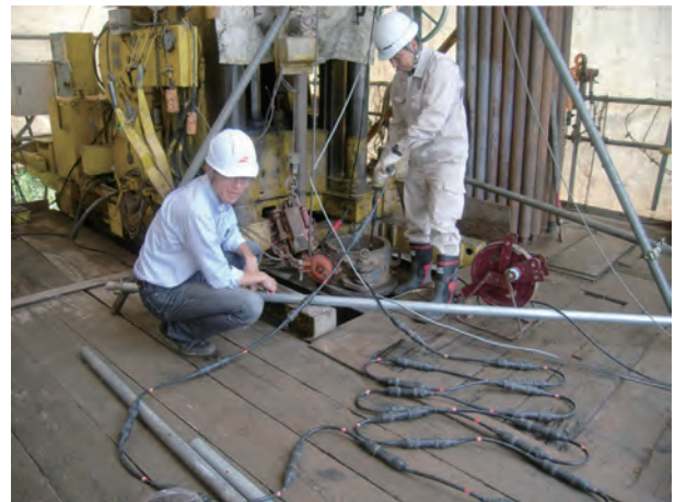
写真6 hidroフォンVSP探査で観測孔へ受振器を投入中。詳細な地質構造を把握するため受振器間隔50cmを採用しました。条件に合わせて1m、2m、5mと受振器間隔を選択でき、深度1,000m級まで対応しています。
