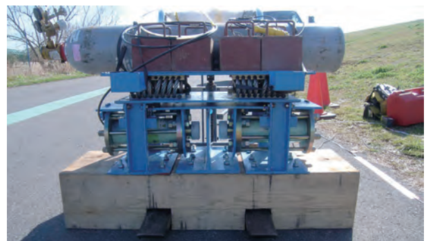
写真7 極浅部の探査用に開発した人力で移動できるコンパクトなSH波震源。エアピストンを2基搭載しサイクリックな右左叩きが可能です。
