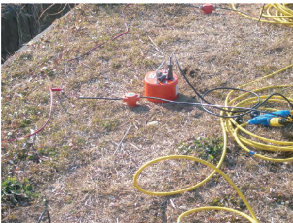
写真5 広帯域の周波数特性を持つMEMS型受振器と従来型2Hz地震計との比較実験中。低周波領域の利用価値に注目しています。
