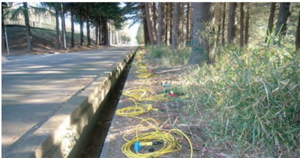
写真4 地震波干渉法のための多チャンネル長時間記録を測定中。従来の反射法地震探査ではノイズとなる周辺交通振動や自然地震などを利用します。
