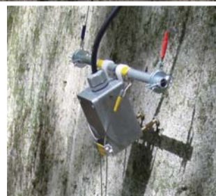
新開発 高感度壁面センサー (DES-0611)
