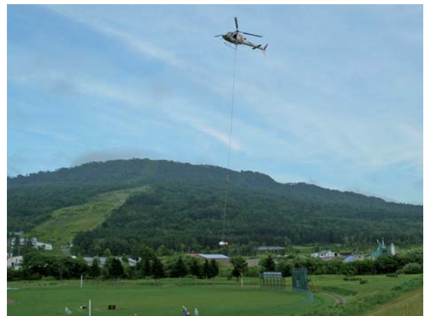
図4 地表ソース型空中電磁法の探査の様子。ヘリコプターから40mのケーブルでセンサーを吊り、その中間にデータ収録装置も吊っています。
