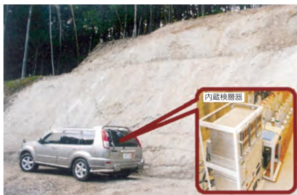
車載型放射能探査装置での測定状況
