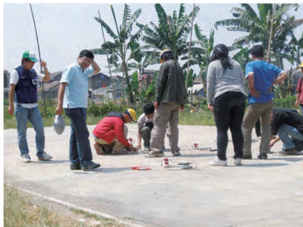
インドネシアでの微動アレイ探査
