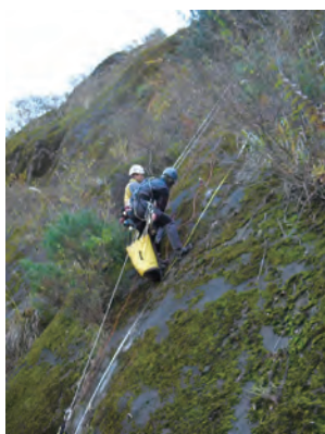
崖の弾性波探査(展開作業)
