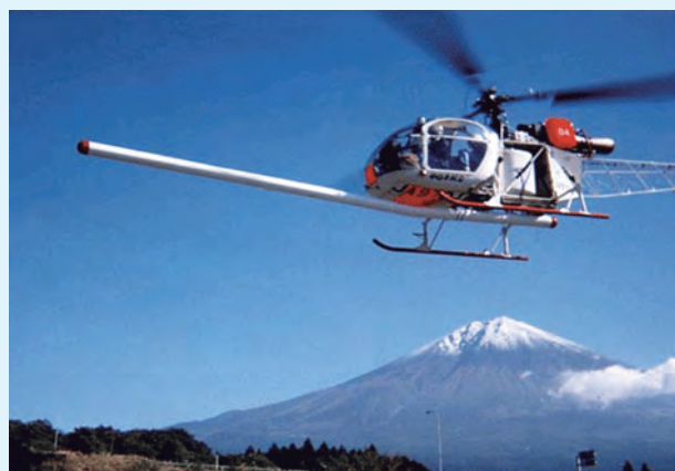
図18 磁力計用スティンガーを装備したヘリコプター
