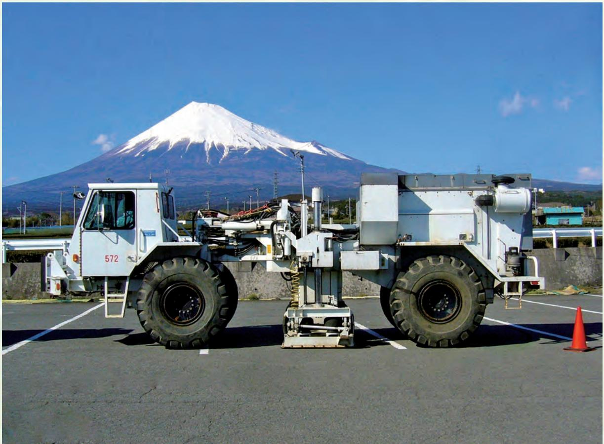
富士とバイブロ：2012年4月に帝京平成大学と静岡大学が行った「富士川河口断層帯一糸魚川静岡構造線横断地下構造調査」(作業担当：(株)地球科学総合研究所)における大型バイブロサイズ。
