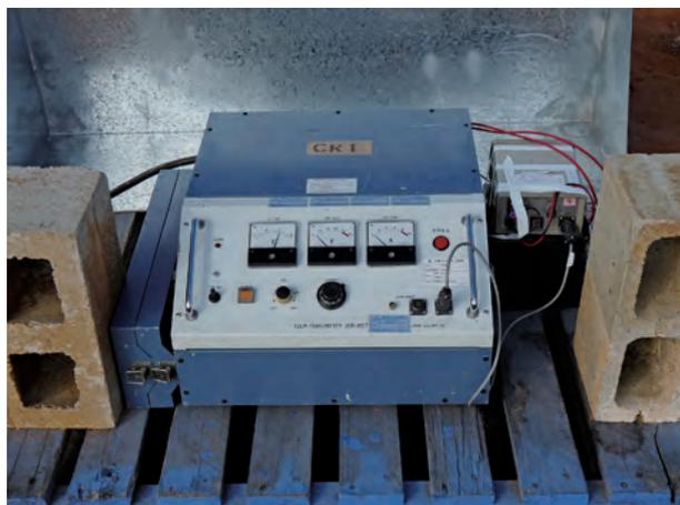
写真7 TDEM法送信器(千葉電子製)
