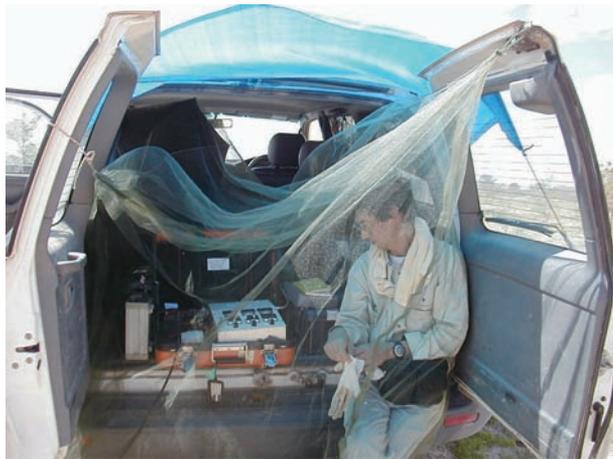
写真5 TDEM法受信状況(蚊帳の中で作業)
