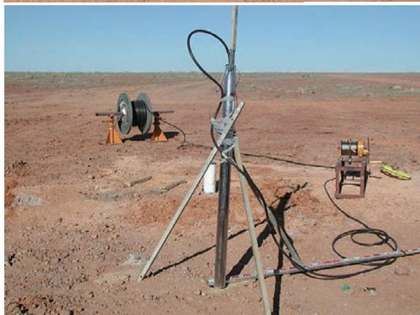
写真6 AEセンサー設置作業状況
