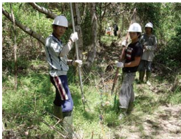
写真6 受振器設置の様子(Planterを利用)
