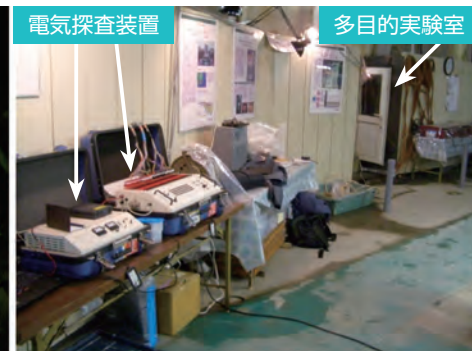
Figure.4 地下空間実験場(地下50m)での電気探査計測風景 (左)立坑(地下から地表を撮影)、(中)電気探査装置一式、(右)多目的実験室での加熱実験
