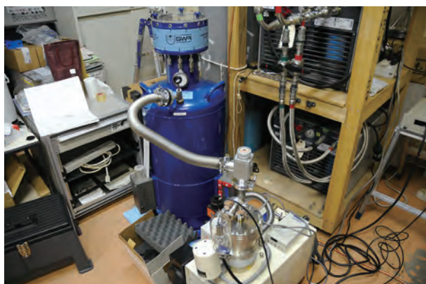
図7 真空断熱槽の真空引き
