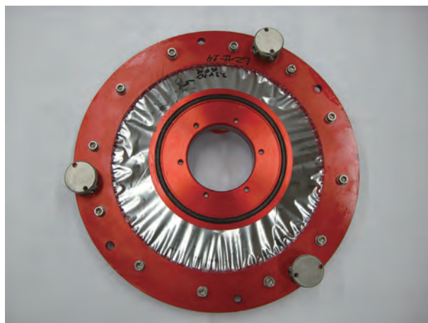
図4 新超伝導重力計のダイアフラム
