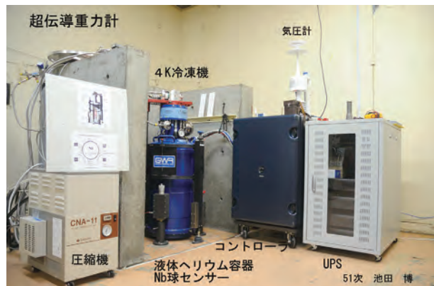
図10 最終的な新超伝導重力計の全体配置図
